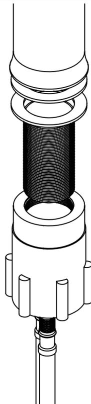
3.- Coloque el monomando sobre el empaque de anclaje y asegure firmemente desde la parte inferior con ayuda de la tuerca de fijación.
