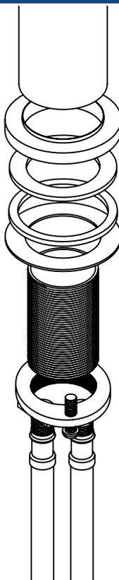
3.- Coloque el chapetón base, posteriormente el monomando sobre el empaque de anclaje y asegure firmemente desde la parte inferior con ayuda de la tuerca de fijación.
