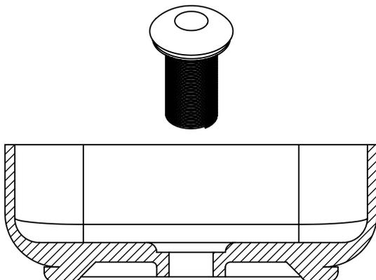
2.- Colocar el empaque de goma y enroscar la tuerca de fijación, utilizar un torque moderado para no dañar la cerámica.
