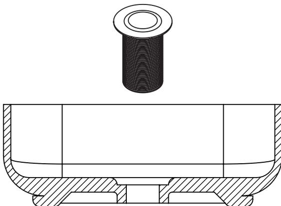
2.- Colocar el empaque de goma y enroscar la tuerca de fijación, utilizar un torque moderado.
